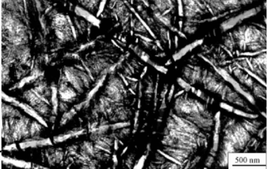
Abb. 3: Die transmissionselektronenmikroskopische Aufnahme eines UHMW-PE enthüllt die spezielle teilkristalline Struktur dieses Werkstoffes (Foto oben: Naumann), der z. B. in verschleißfesten Hüftgelenksprothesen (Abb. links) eingesetzt wird.
