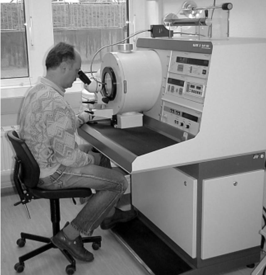
Mit dieser am Biozentrum installierten Gefrierbruch/Gefrierätzapparatur können Oberflächenstrukturen, wie z. B. (unten): ... die von Bakterien, über eine spezielle Replikatechnik dargestellt werden.
